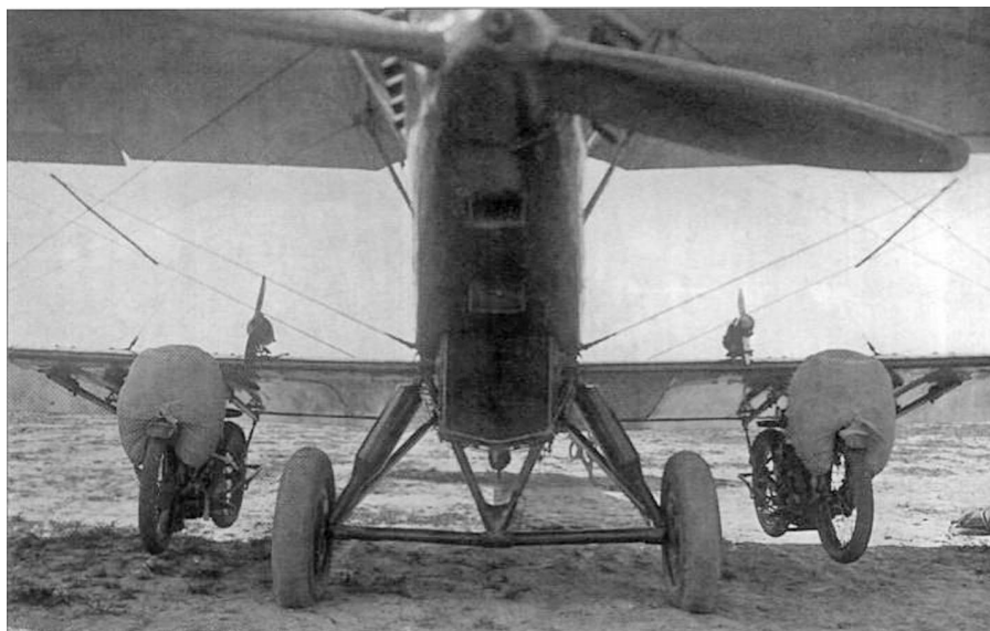
Подвеска мягких парашютно-десантных мешков на штатные подкрыльевые балки самолёта Р-5, 1935 г. Обратите внимание на фалы принудительного раскрытия парашютов.
